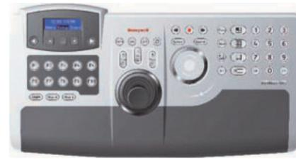
HJC5000 包含一个触摸盘便于快速选择摄像机或视频录像设备，以及一个具有四个按键的触摸环用于各种功能操作，专用的 DVR/NVR 按钮可编程用于设备控制，操作摇杆灵活控制快球摄像机的转动方向、角度变化、焦距调整等。激光切割蓝色背光键盘提供无褪色、熟悉的 QWERTY 键盘感和橡胶支撑手腕，符合人体工学设计理念。
