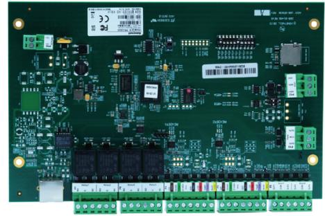
PW6K1IC-P 按照脱机运行的理念来设计的，可以脱离计算机或其他控制装置而独立实施门禁控制。该控制器还可与主计算机连接来进行系统配置、报警监控和直接控制。与主计算机的连接通过 TCP/IP 网络连接实现。
