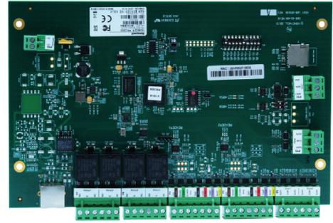
PW6K1R2-P按照脱机运行的理念来设计的, 可以脱离计算机或其他控制装置而独立实施门禁控制。该控制器还可与主计算机连接来进行系统配置、报警监控和直接控制。通过 TCP/IP 网络连接实现远程升级。
