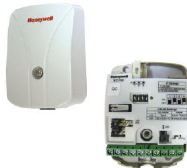
SC 系列振动探测器外形小巧，内置传感器、信号标准模块、微处理模块、DIP 开关模块、输出报警模块等，当检测到攻击时，探测器根据检测到的信号进行精确分析和判断，将振动信号转化成电信号，并按照预先设置的多种灵敏度等级触发报警、防止外部入侵。
