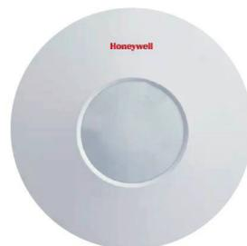
DT8040CM 支持360°范围的菲涅尔透镜式被动红外入侵探测以及X-Band微波入侵探测。设计采用三重透镜组合覆盖被动红外探测视野以及被动红外灵敏度调节，具备微波探测距离调节。小巧人性化的外壳设计可以让安装人员在几分钟内完成接线。
