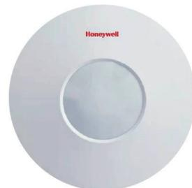
IS3040CM 支持360°范围的菲涅尔透镜式被动红外入侵移动探测。设计采用三重透镜组合覆盖被动红外探测视野以及被动红外灵敏度调节,具备先进的自动温度补偿算法。小巧人性化的外壳设计可以让安装人员在几分钟内完成接线。
