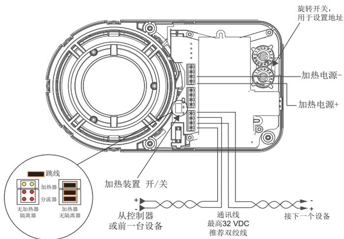
图 2-14: 探测器侧接线示意图
