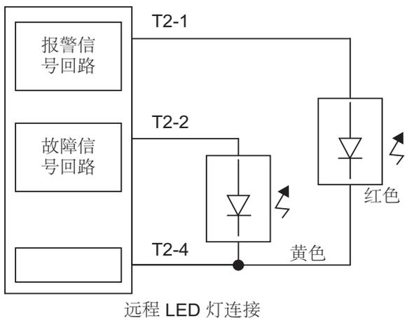
图 2-16: 接线示意图 (远程 LED 灯)
