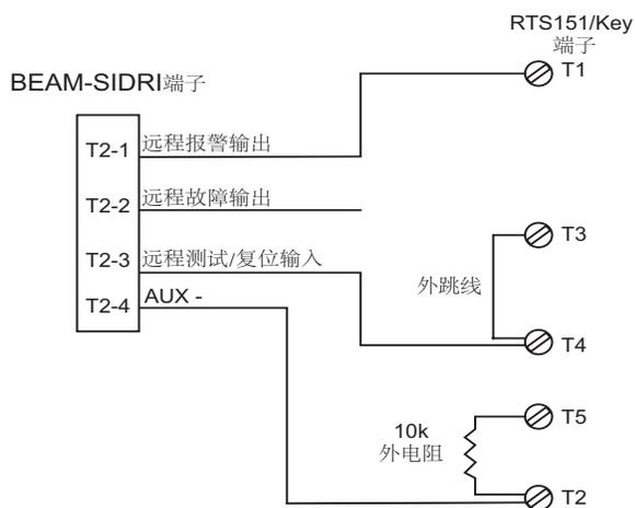
接线：0.8mm<sup>2</sup> 单2对电缆，无屏蔽。
