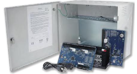
PRO42IC 智能控制器支持下挂多达 16 个任意组合的输入 / 输出或读卡模块，用于报警点监控，外部设备控制以及门禁读卡器接入。在 WINPAK® 4.9 及更高版本上，PRO42IC 板载还可为 2 个门管理提供输入 / 输出以及读卡器接口，从而通过一个智能控制器提供多达 34 个门的管理，并支持高达 10 万张的卡片容量以及 5 万条脱机存储的事件容量。
