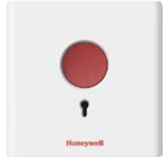
PB1086 支持常闭或常开可选的接线方式。封闭式结构设计，免拆底壳安装接线，降低产品在安装中的损坏几率。底座适配国标86底盒，磨砂圆角外壳设计，无指纹残留且美观大方。
