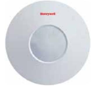
DT8040CM 支持360°范围的菲涅尔透镜式被动红外入侵探测以及X-Band微波入侵探测。设计采用三重透镜组合覆盖被动红外探测视野以及被动红外灵敏度调节，具备微波探测距离调节。小巧人性化的外壳设计可以让安装人员快速便捷完成接线。
