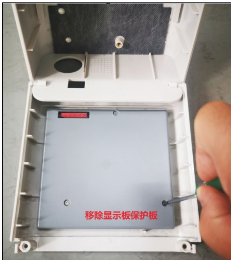
图 34: 移除屏幕保护板
