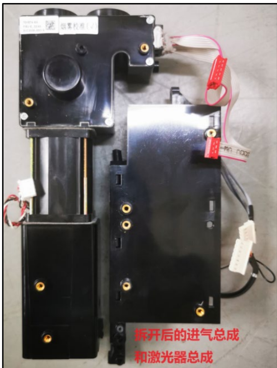
图 40: 分离后的进气总成和激光器总成
