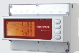
HEM 系列三相电子式多功能仪表 (DIN35mm 导轨式安装) 是一款集测量记录、电能计量、远程抄表、大屏幕 LCD 显示功能于一体的多功能仪表。本仪表可测量电压、电流、功率、功率因数和频率等多项电网参数；可计量有功和无功电能；具有单 / 复费率电能；可配置一路 RS-485 通信接口，支持 MODBUS-RTU 和 DL/T645-2007 双通信规约；可配置开关量输出功能。
