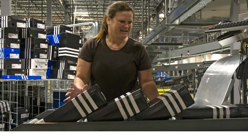
导入站的工人将鞋盒堆叠放置,从而对分拣机启动"多 米诺"效应。
