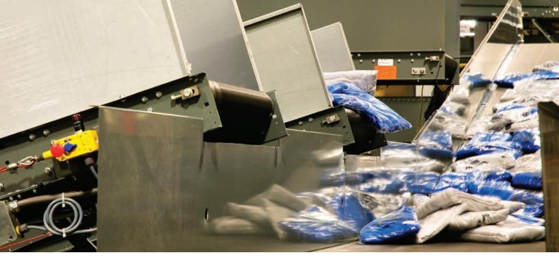
储存箱转储系统通过一个输送机 "瀑布" 将批量拣 选的物品传输到导入站。
