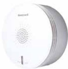
JTYJ-GD-HS90/BW 独立式感烟火灾探测是一款由霍尼韦尔公司推出得专门用于保护家用住宅的高性能独立式的点型感烟火灾探测器。产品以最大限度降低室内火灾损害为目的，当烟雾浓度达到报警阈值时，报警器发出声光信号，提示您采取保护措施保障生命财产安全，并通过无线通讯方式进行远程通知。产品采用低功耗设计，独立工作，安装方便灵活，仅使用 2 节 AA 碱性电池供电，即能使产品待机寿命长达 3 年。
