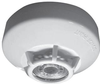
该探测器是二线制差定温型感温探测器,设计这类探测器是为了对开放式区域提供保护,且需与兼容的控制器配套使用。采用现代工艺技术的热敏元件快速反应电路。可适用于各种恶劣环境,维护简便,故障率低。使用时,需通过普通探测器接口模块接入控制器回路总线,所用底座为B701。(底座需另外订购)
