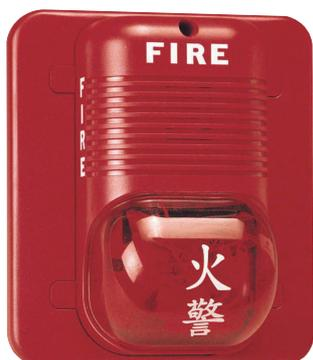
该款声光报警器可发出变调声响及脉冲信号以示火警,光照度可达75坎德拉,24VDC供电,外形美观,特别适合于宾馆、饭店使用。客户可选择灯罩上有无“火警”字样。声光还可独立工作。
