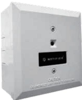
ISO-9G短路隔离器: 当回路有短路发生时, 它可保证回路的其余部分能正常工作。模块上有一个LED指示灯, 正常时闪亮, 有短路发生时变为恒亮。当故障被排除后, 模块能自动使整个通讯回路恢复正常。
