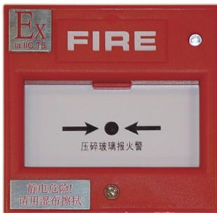
J-SAP-M-M500KEIS防爆型手动报警按钮为开关量信号控制系统器件。它与相兼容的控制器配套使用可通过KM-FZM-1C监视模块接入NOTIFIER控制器。当发现火灾情况时,手动压碎玻璃片使监视控制器发出报警信号,同时其上的LED灯恒亮,显示报警状态。
