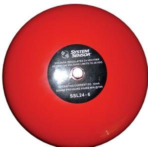
SSL24-6警铃是一个低电流高分贝的声音警报装置。由24VDC电动机驱动,适用于防火、防盗和其他声音信号传输系统, SSL24-6警铃具有正负极性,便于监控电路系统配套使用,警铃下向钟锤设计,铃盖采用铝制材料制成,可发出大的共振音。
