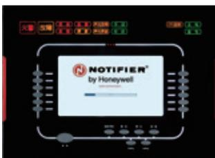
控制器主面板采用像素为800\*480的7寸彩色TFT液晶显示屏。液晶显示屏作为控制器的显示、操作部件，可以显示、记录系统中发生的各类事件。同时，用户还可通过简单的功能按键完成系统复位、本地消音及声光设备控制等操作。此外，设备的启动/停止、屏蔽/恢复、事件手动查询、历史纪录查询及其它系统操作等也可在本显示器上完成。
