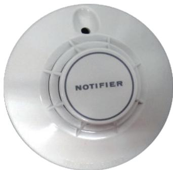
JTW-BD-FST-951G点型感温火灾探测器探测火灾产生的热量并将探测到的温度模拟量报告给控制盘。由于采用了模拟量信息，从而使得用户、安装人员和维护人员能够得到比普通型系统更多的信息。同时，由于该探头是可编址的，所以可以使消防人员更快地确定火灾地点。如需配置蜂鸣器底座，请订购B601BH。
