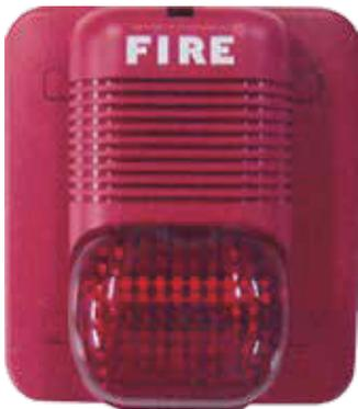
该产品是一个可编址的声光报警器。它与控制器进行通信，控制器发命令码使报警器的声光动作或复位。报警器可以将外部供电电源的故障和正常状态传给智能控制器，以便控制器报出外部电源的状态。声光报警器的地址由手持式电子编码器设定，地址范围为0~199。
