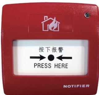
J-SAP-M-M900KG型手动火灾报警按钮是和霍尼韦尔消防安防(上海)有限公司产品相兼容的控制器配套使用的一种火灾报警器件。它是一专用的手动报警按钮，安装在两总线制通讯电路上，当发现火灾情况时手动按下操作面板，控制器发出报警信号，同时按钮上的LED灯显示报警状态。(手报安装盒需另外订购)
