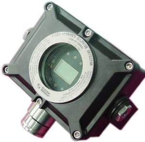
600系列气体探测器中的可燃气体探测器是一款高性能的气体探测器,内置MCU,高品质英国CITY传感器,结合先进的数字处理技术,可对室内外环境中各种可燃气体进行全面监控,并将监测信号输出给气体报警控制器。该探测器也可方便的接入其他二次仪表和控制系统中,外壳采用铸铝合金,表面烤漆,防水,防尘,耐腐蚀,防爆等级为Exd IIC T6,防护等级为IP66,能够满足各种环境的要求。
