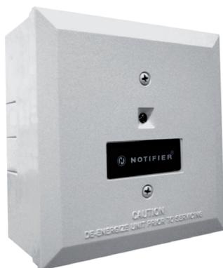
故障隔离器模块对SLC回路中导线间的短路自动进行隔离。当SLC回路中出现短路故障时,故障隔离器可限制受故障影响的探测器数量。当短路情况排除后,故障隔离器模块将自动重新接通SLC回路中的隔离部分。故障隔离器模块不需要任何地址设定,并且是全自动操作。故障隔离器模块安装在4英寸深的标准接线盒中,表面安装盒中或火警控制器中。它带有一个LED,在隔离器正常运行时闪亮,在检测到并隔离短路时常亮。(每个继电器底座相当于3.5个设备,每个B501底座、每个智能模块相当于一个设备)。在隔离器ISO-X之间最多可连接25个设备。(模块安装盒需另外订购)
