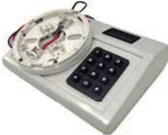
NFS2-3030C配接的951G系列智能探测器和模块的电子编码设备，需要电子编码器现场对其进行地址设置。图示编码器内置中央处理器(CPU)，两节9V电池供电，带数字键盘及液晶显示。通过该设备可对951G系列智能探测器和模块进行地址设置。用户通过数字键盘输入要设置的地址(显示在液晶屏上)，确认后，该地址写入探测器或模块。此外，该编码器也可以用来读取已编址的设备的地址，并在液晶屏上予以显示。
