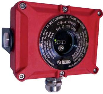
点型红外火焰探测器(多参量)是一种工业防爆型产品,它基于探测火焰所发出的红外线特征和探测现场红外辐射场的变化,将现场采样来的各种参量经先进的智能算法处理来判断火情是否存在。与其他火焰探测器相比较,其响应速度快、可靠性高、判断准确。适用于易燃易爆环境中明火及阴燃阶段的火灾探测报警,尤其适合于探测有机物的燃烧,可广泛应用在交通隧道、石化企业、造纸、钢厂、核电站、发电厂、食品加工企业、军工企业等。
