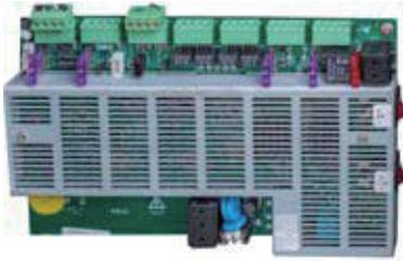
控制器给控制器、回路设备提供24V直流电源，并给备用电池充电。同时，电源监控主电和备电的状态，将电源的故障及时告知CPU并显示，并实现对主电、备电的管理。
