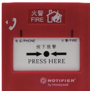
火灾发生时,人为按压塑料片,按钮的火警灯即亮,控制器发出报警音响并显示报警位置。安装位置设置在楼梯口等处,距地面高度约1.5m。
