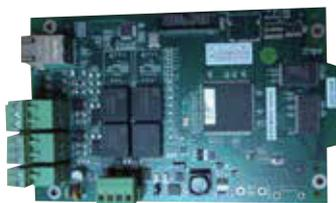
LPI-MODBUS-V3回路接口通讯卡是一个SLC-ModBus转换器。该转换器将SLC回路设备映射成ModBus寄存器，从而使得以Modbus/RTU通信协议进行通信的第三方系统可以接入Notifier的火灾报警控制器。第三方系统包括Honeywell和其它供应商开发的系统或软件。
