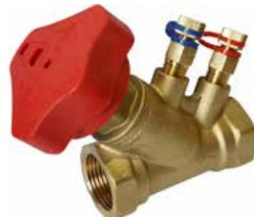
霍尼韦尔 VSBC 系列静态平衡阀主要安装在中央空调水系统的支干管或者末端支管上，也可应用于其他的相同或相似功能需求的场合。
