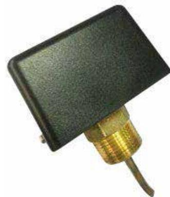
WFS8000 水流开关可以安装在户外, 但需注意防雨, 可以水平或垂直安装在管道中, 需保持两边 5 倍的管道直径的均流管道。
