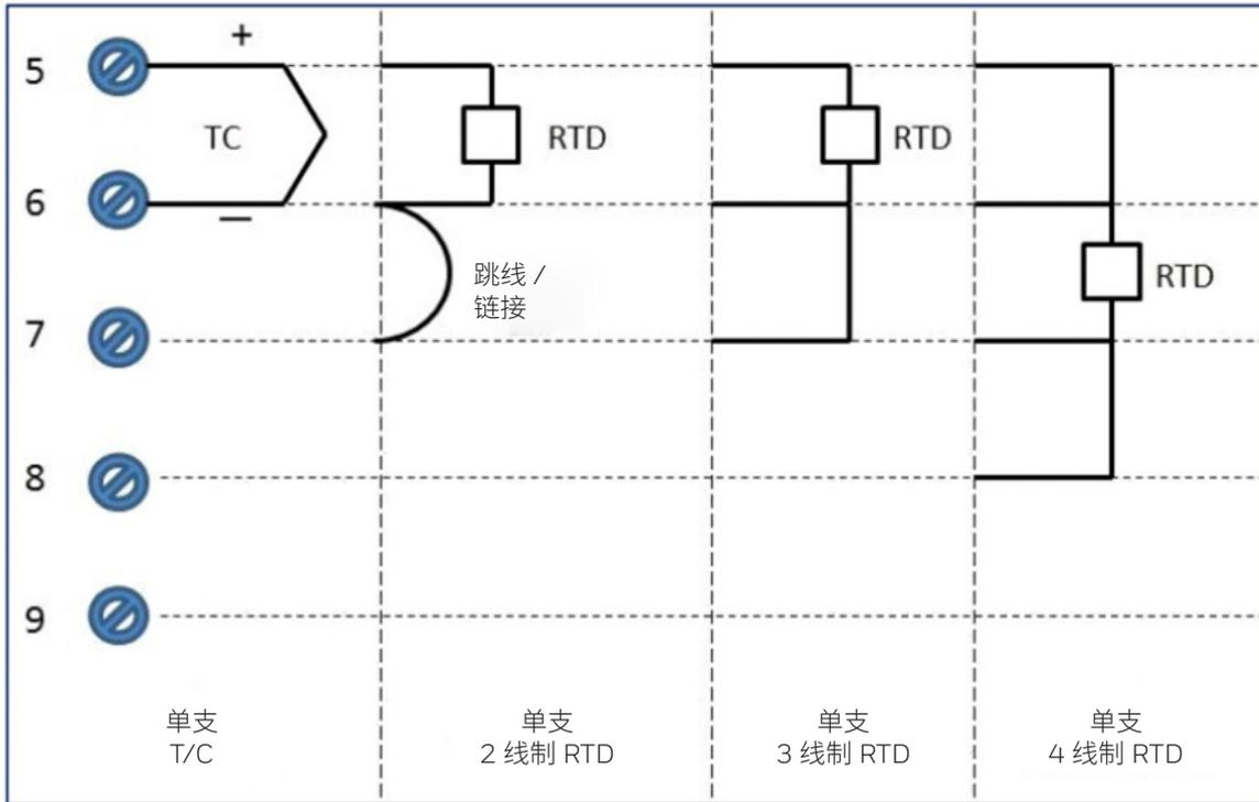
图 3 - 温度传感器接线图
