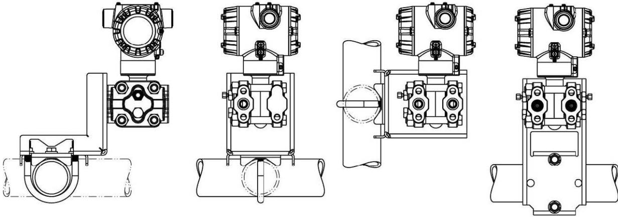
图4 - 安装配置
