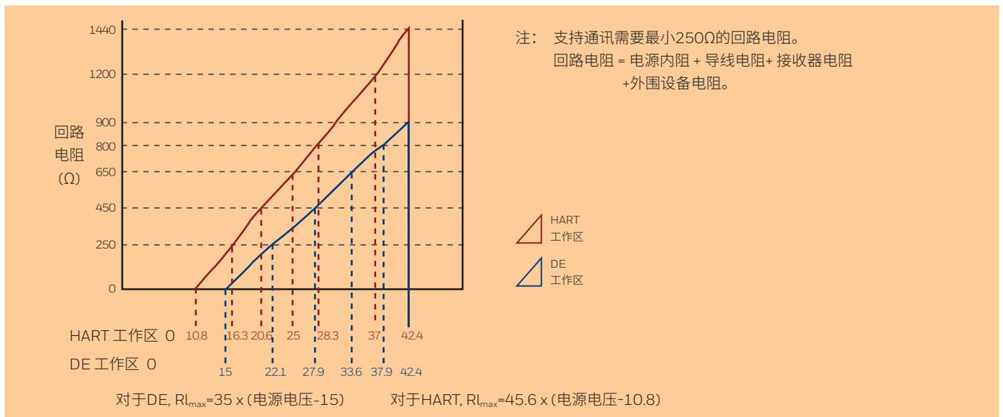
图2 – 供电电压及环路阻抗图标与计算 (HART/DE协议)
