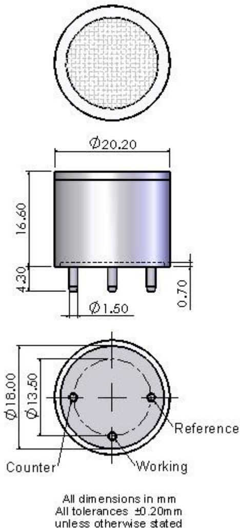
**Note:** 推荐使用 PCB 插座来连接传感器，焊接会损害传感器。
