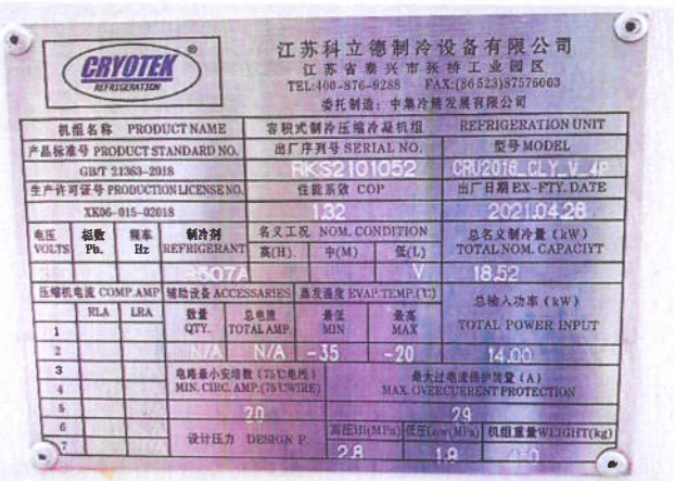
低温冷凝机组铭牌
