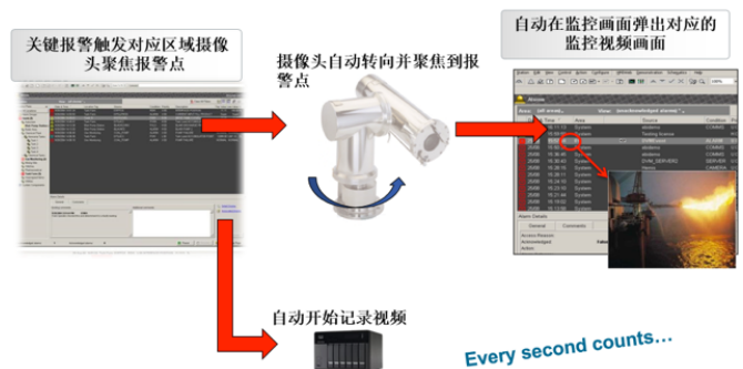
霍尼韦尔 Experion 系统与 CCTV 视频监控的无缝集成
