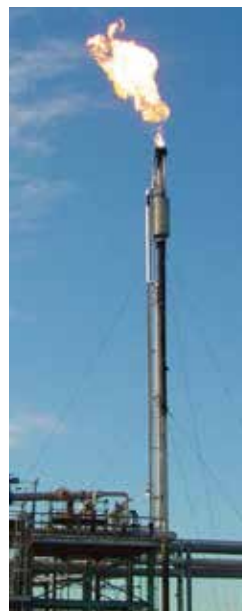
上部蒸汽火炬的火炬测试
